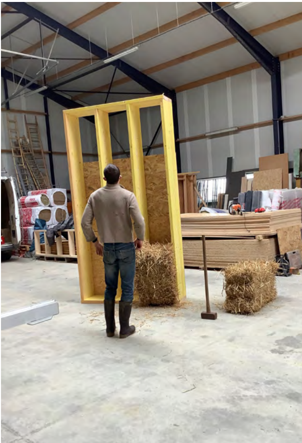
Essai d'isolation d'un pan de mur en ossature bois pour vérifier le dimensionnement des bottes de paille.
